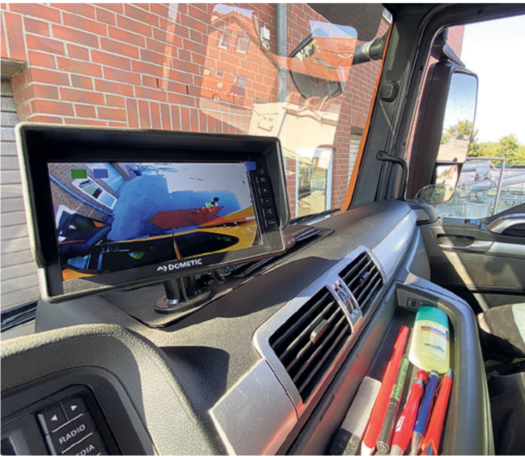
▲ Mehr Sicherheit für alle. Das Display zeigt, was die Spiegel nicht immer erfassen: Achtung, neben dem Fahrzeug befindet sich eine Person!
