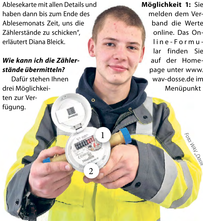
Trinkwasser-Azubi Julius Kowalzik zeigt, welche beiden Angaben für die Ablesung wichtig sind: 1) der Zählerstand und 2) die Zählernummer.
